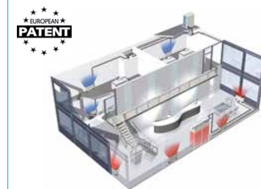
Ejemplo de instalación de una cortina de aire combinado con sistemas ERQ y VRV.
